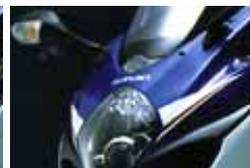
Lo sviluppo in galleria del vento ha definito la carenatura della **Gsx R 1000 k8**, con uno stile aggressivo e con una sezione frontale complessivamente ridotta per migliorare le prestazioni aerodinamiche.
